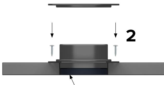
**1** PLASTIC SPACER FLUSH WITH CEILING
