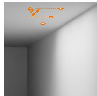
La **distance entre les appareils d'éclairage (S)** doit être la plus petite par rapport à la distance (D) du mur et la plus grande par rapport à deux fois la distance (D x 2) du mur
