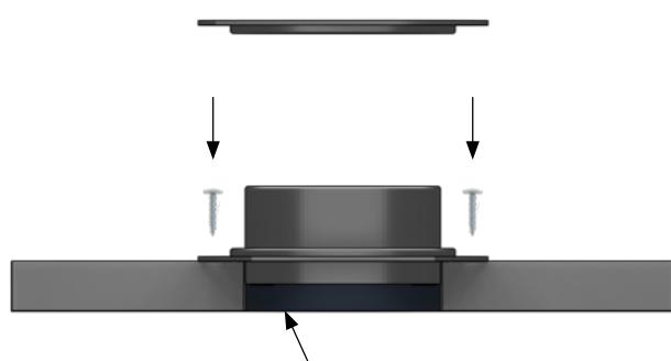
**EN: PLASTIC SPACER FLUSH WITH CEILING**
